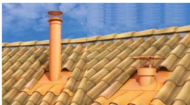
En fait, c'est la norme NF DTU 64.1 qui sert surtout de référence. Cette norme distingue deux sortes de ventilation : pour la ventilation primaire, l'entrée d'air est assurée par la canalisation de chute des eaux usées ; pour la ventilation secondaire, la conduite de sortie d'air doit être raccordée au-dessus du fil d'eau ou sur la canalisation en sortie de fosse avant la filière de traitement.
